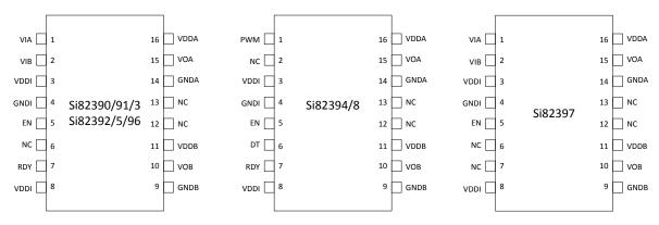
Figure 6.1. Si8239x SOIC-16<sup>1</sup>
