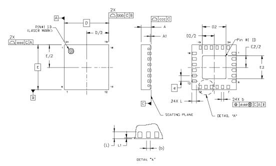
Figure 25. 24-Pin Quad Flat No-Lead (QFN)
